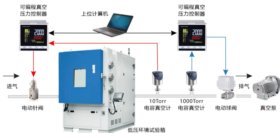
图2 低气压试验箱真空度程序控制系统结构示意图
