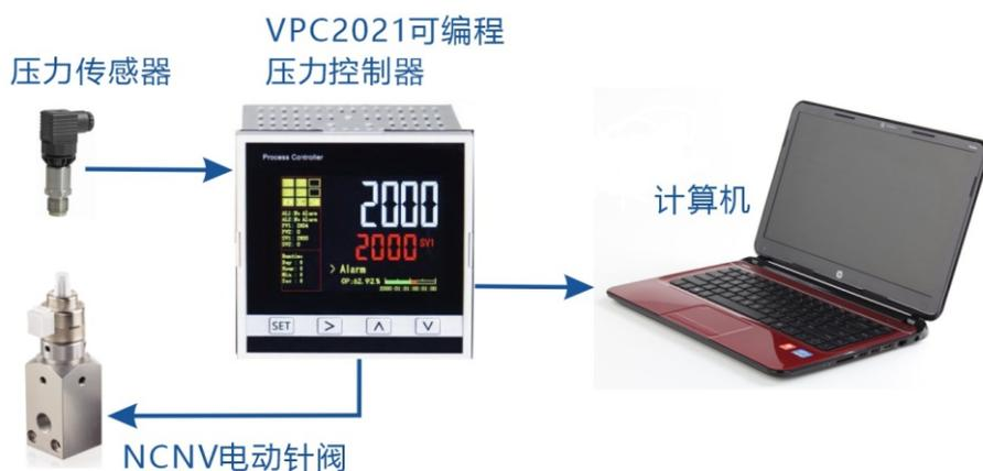
图3 电控针阀可编程压力自动控制结构示意图
