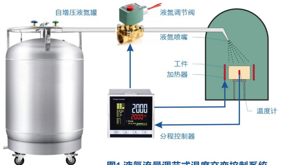
图1 液氮流量调节式温度交替控制系统
