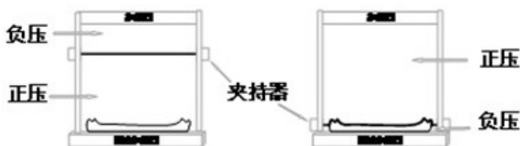
图3 正负压加热成型过程示意图
