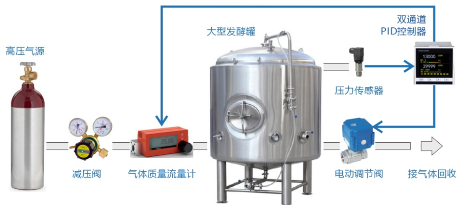
图2 分体式压力控制装置结构示意图
