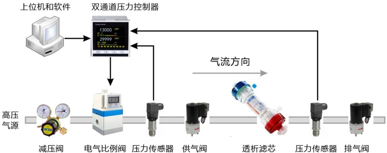
图3 血液过滤芯气密性检测系统结构示意图
