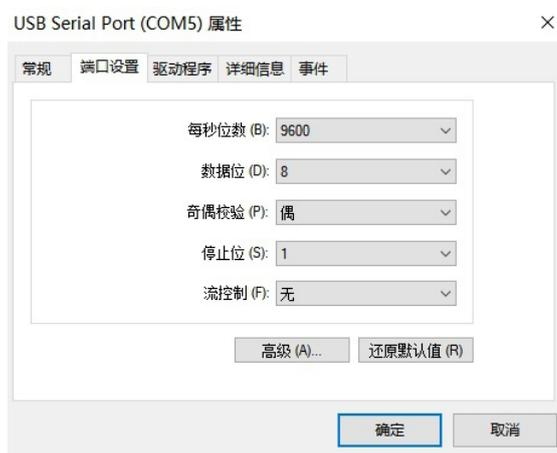
图3 串口通讯参数设置
