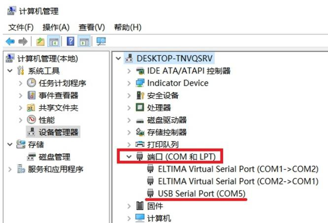
图2 USB串口通讯端口
