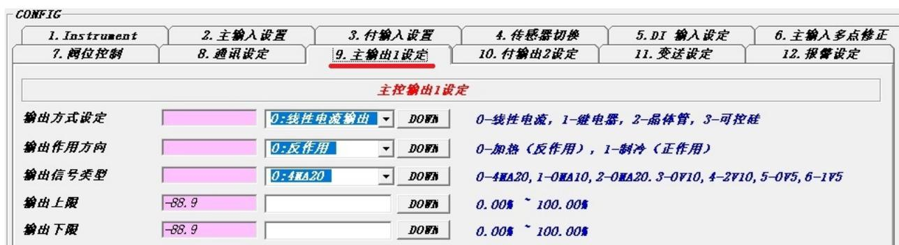
图11 软件CONFIG界面中的主控输出1的参数设置
