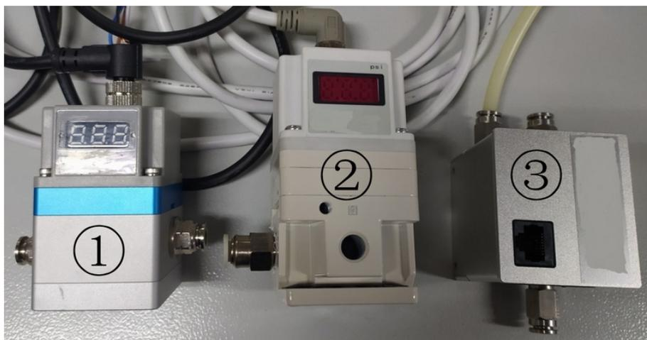
图1 用于考核试验的三种典型电气比例阀
