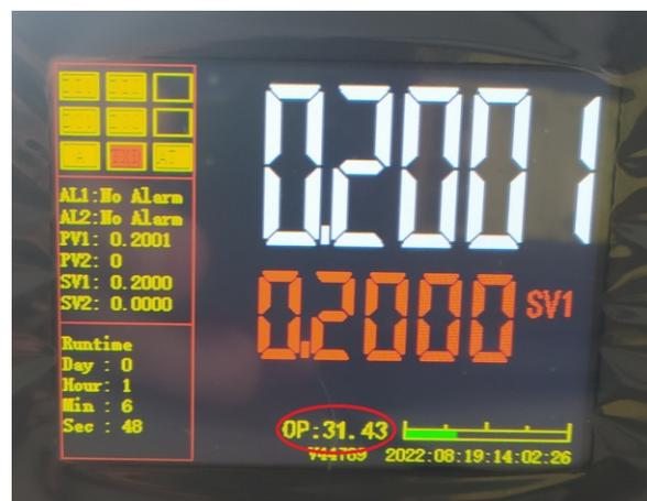
图3 超高精度PID控制器屏幕显示
