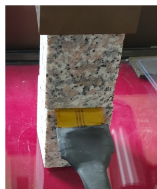
图2 大理石热导率测试
