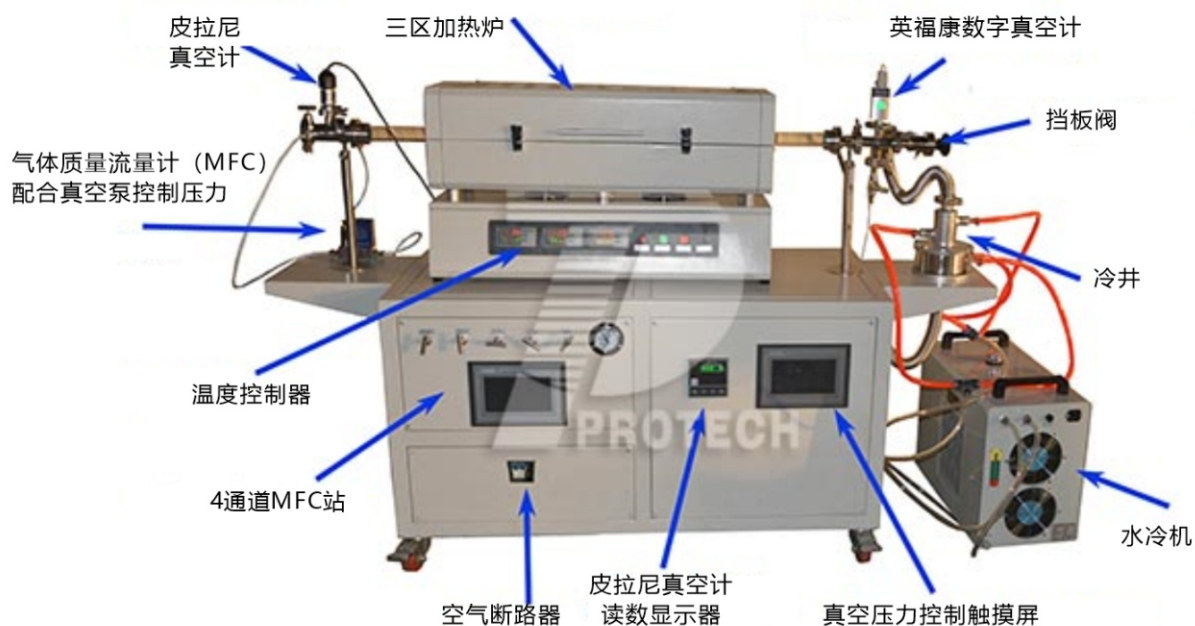
图1 用户购置的CVD管式炉及其结构内容
