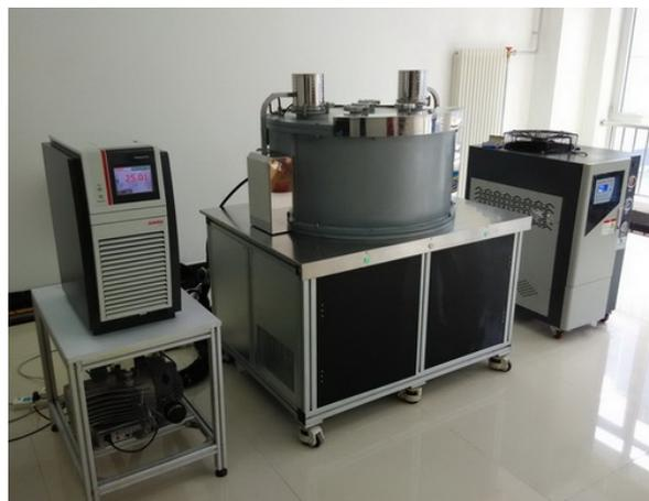
图2 上海依阳公司TC-HFM-1000热流计法导热仪
