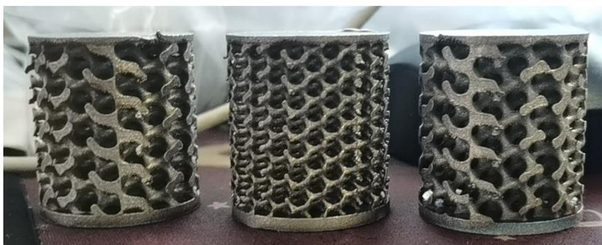
图 1-2 TPMS 晶格结构钛合金多孔材料
