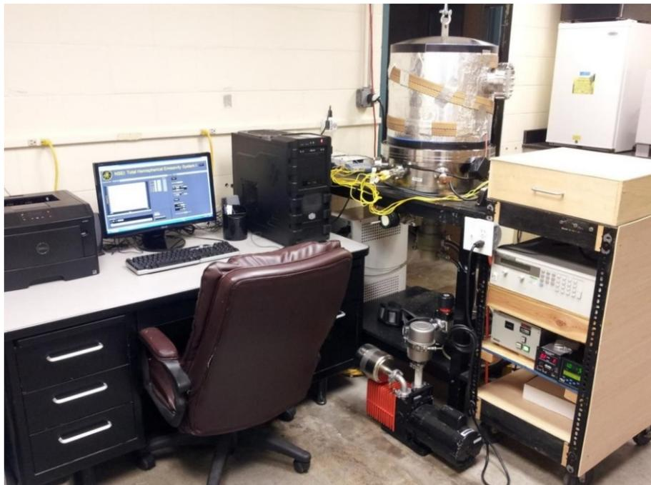
图 2-8 密苏里大学量热法总半球发射率测试系统
