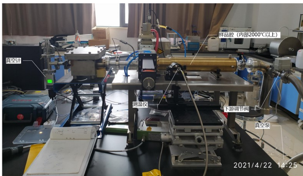
图 5-1 微波等离子体高温热处理系统
