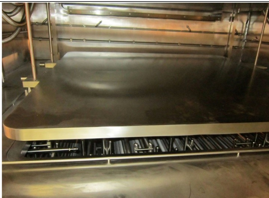
图 3-2 在该冷冻干燥机中，冷凝器位于腔室下方，由液压驱动板隔开
