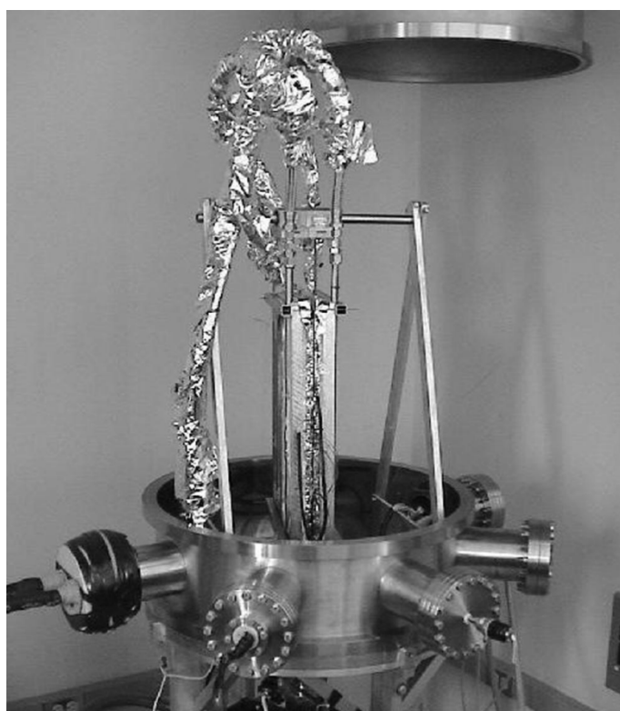
图 1-1 ASTM C 1114 薄加热器真空绝热板导热系数测试系统
