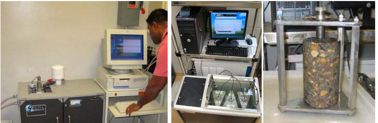
图 8-1 在 FHWA 混凝土实验室使用的测试设备测量混凝土的 CTE
