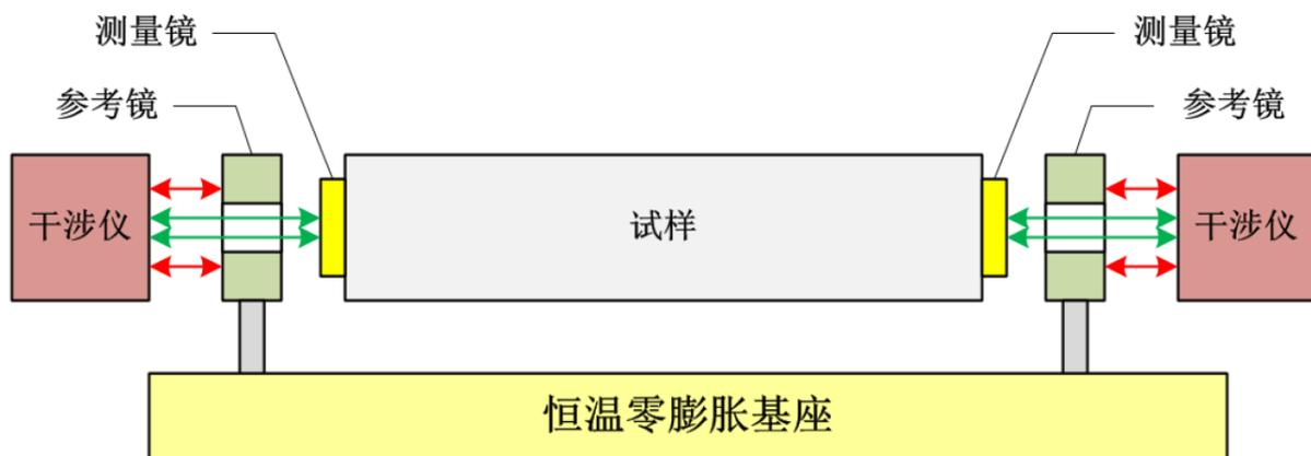
图 2-3 双端测量结构示意图
