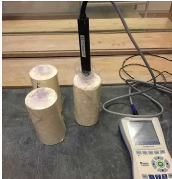
图 3-5 瞬态热线法装置 ISOMET
