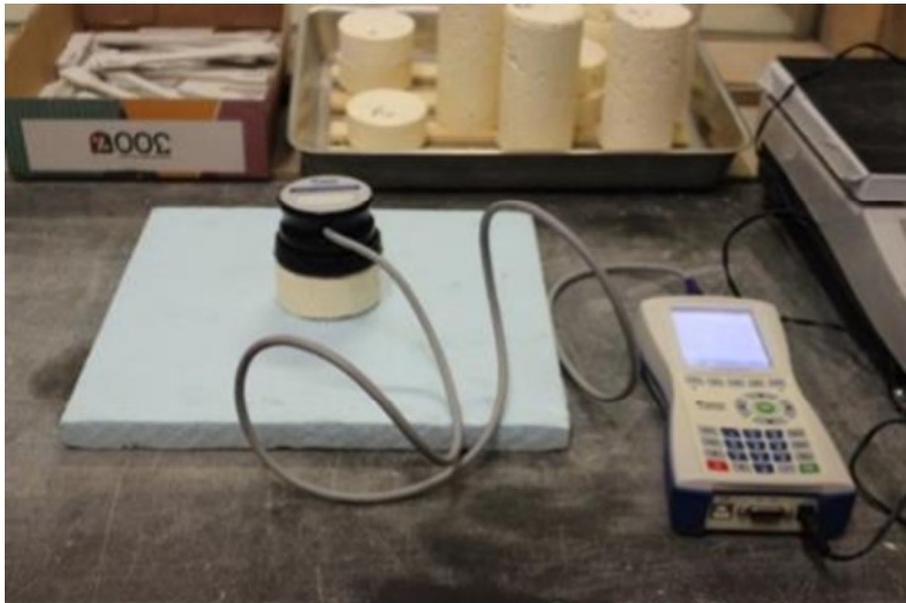
图 3-4 改进型瞬态平面热源法装置 ISOMET
