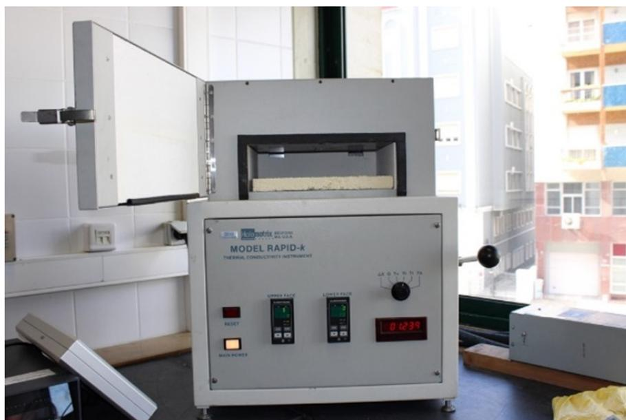
图 3-2 热流计法导热仪
