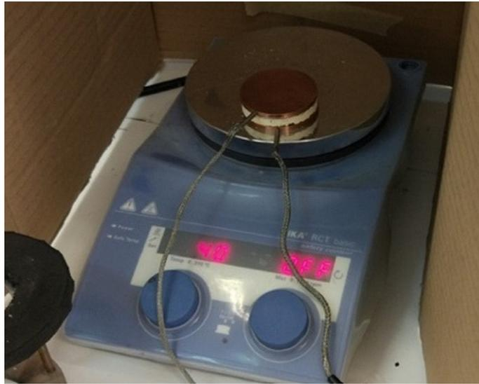
图 3-3 Lee 式热盘稳态法测量装置
