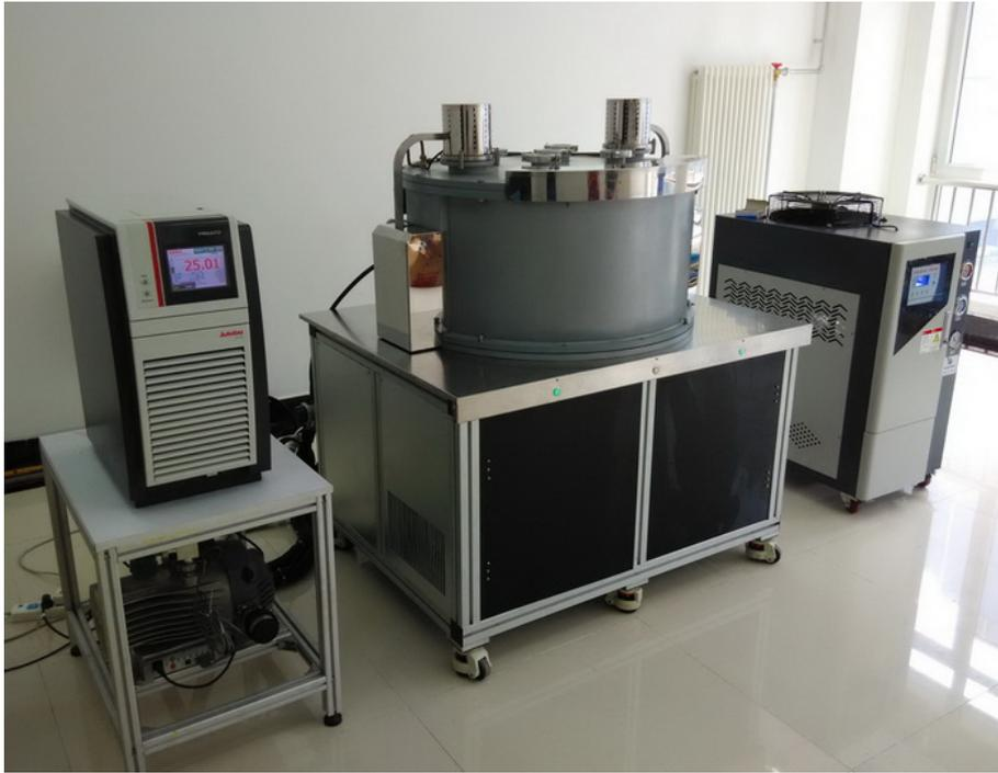
图 2-3 上海依阳公司热流计法高温导热仪
