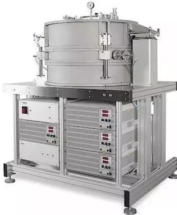
图 2-5 德国耐驰公司高温保护热板法分析仪
