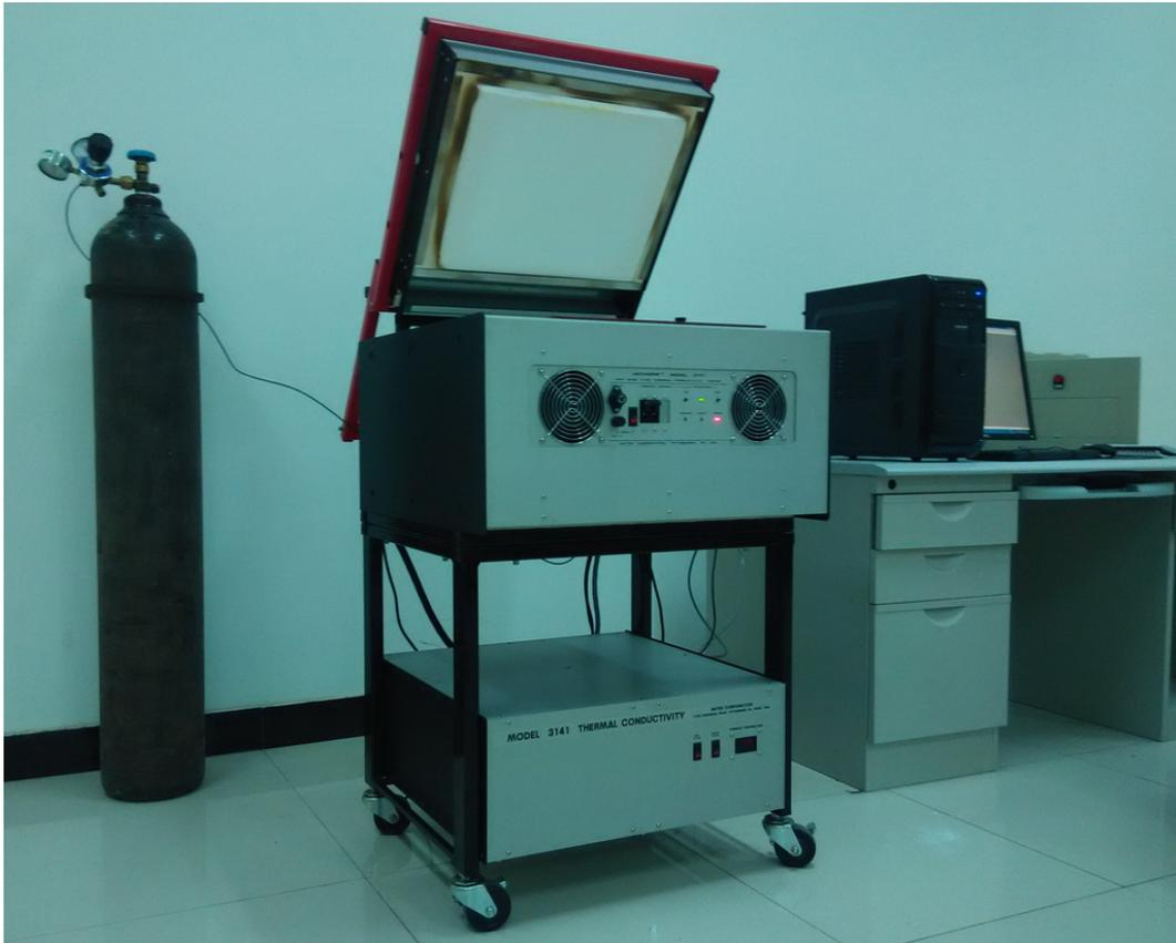
图 2-9 美国 TA 公司热线法高温导热仪
