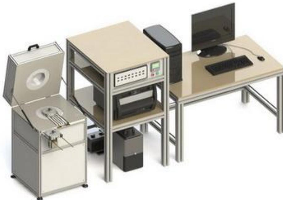
图 4-1 依阳公司瞬态平面热源法中温导热系数测试系统
