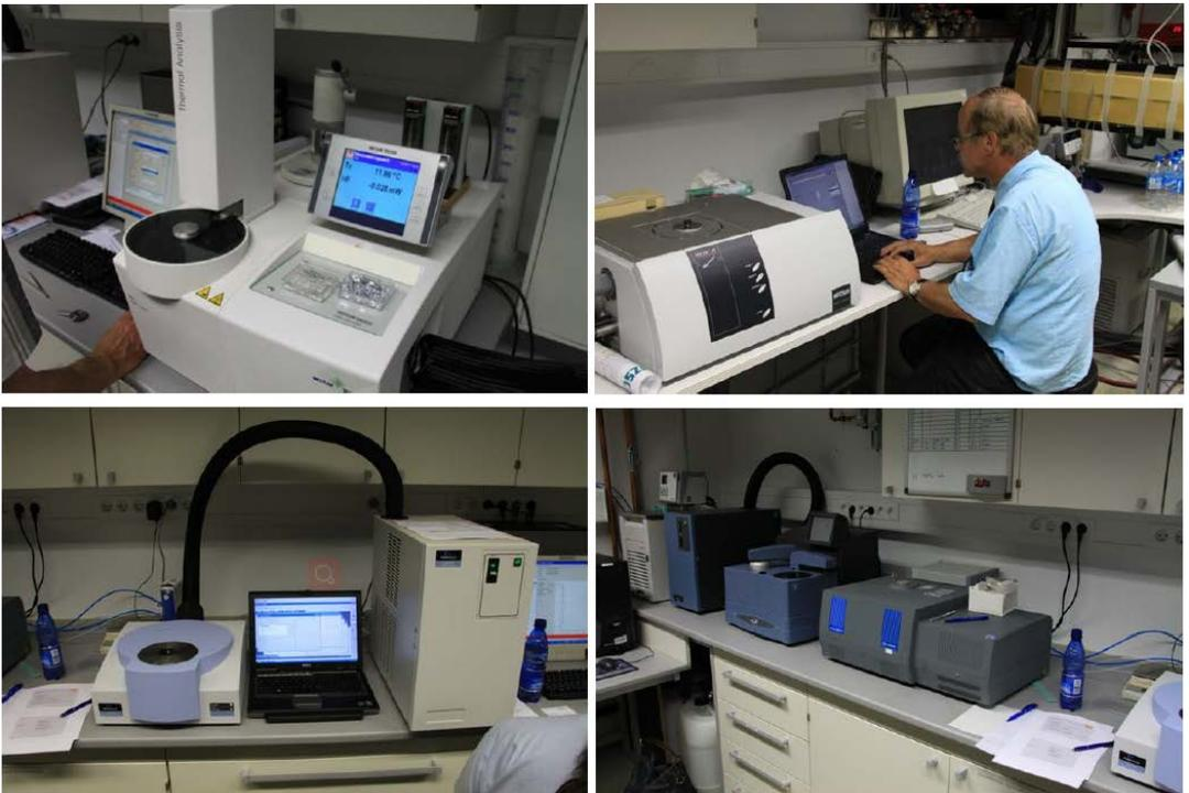
图 3-12 工作组所用的各种 DSC 仪器，从顶部顺时针方向依次为 Mettler Toledo、Netzsch、TA 和 PE 公司
