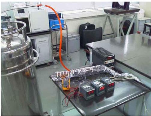
图 2 热管性能测试实验装置
