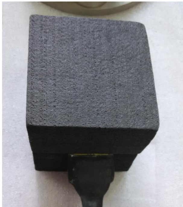
图 3-2 石墨硬毡瞬态平面热源法测试
