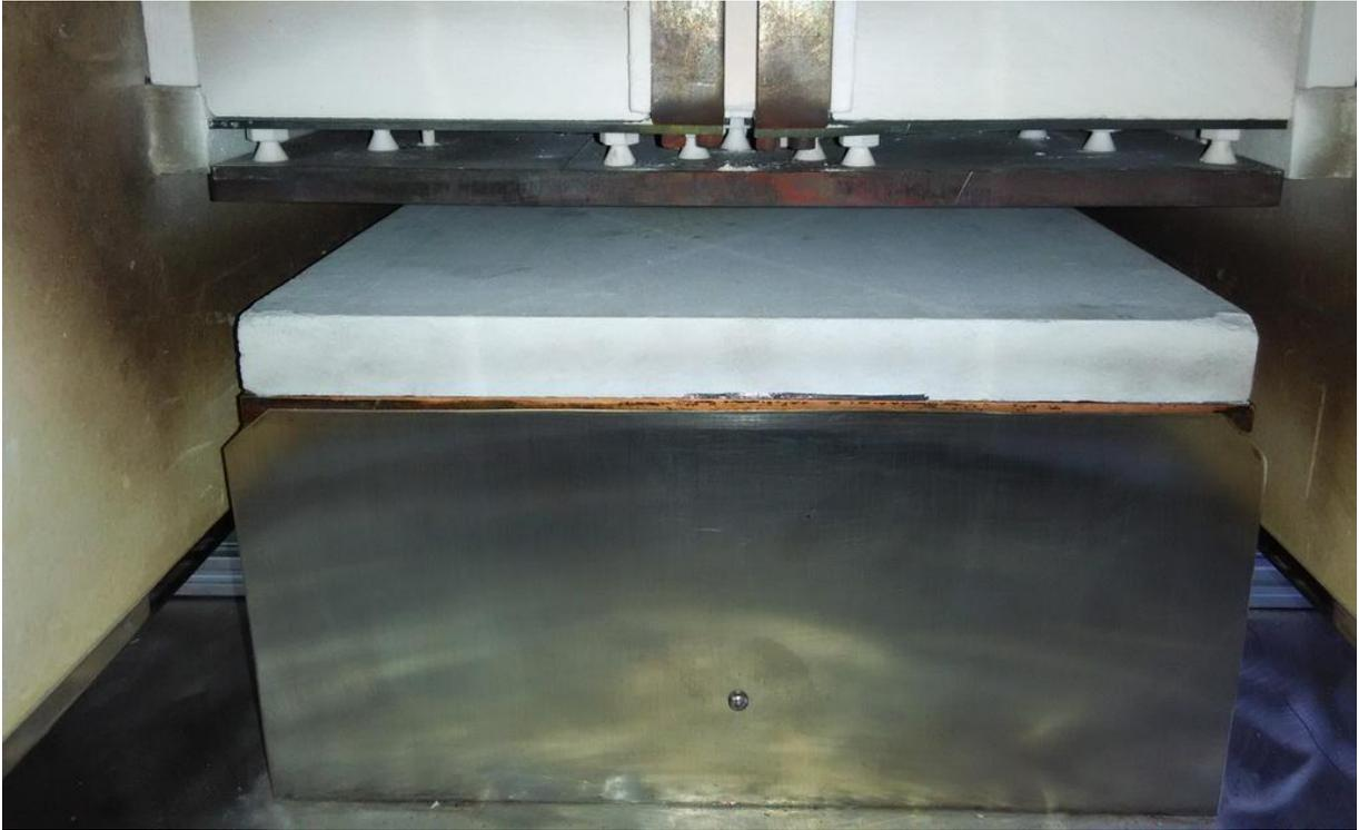
图 3-1 装入高温热流计法导热系数测试系统中的被测试样
