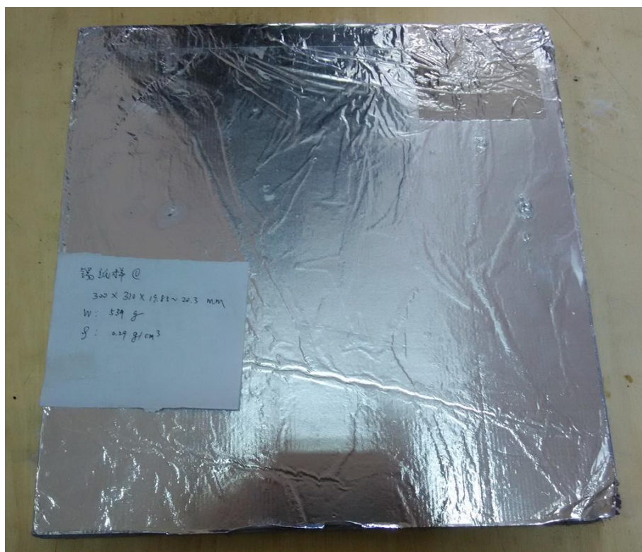
图 2-3 纳米超级隔热材料 1 号试样
