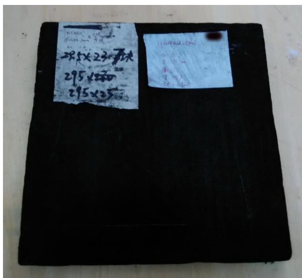
图 2-7 纤维增强碳气凝胶隔热材料 1 号试样
