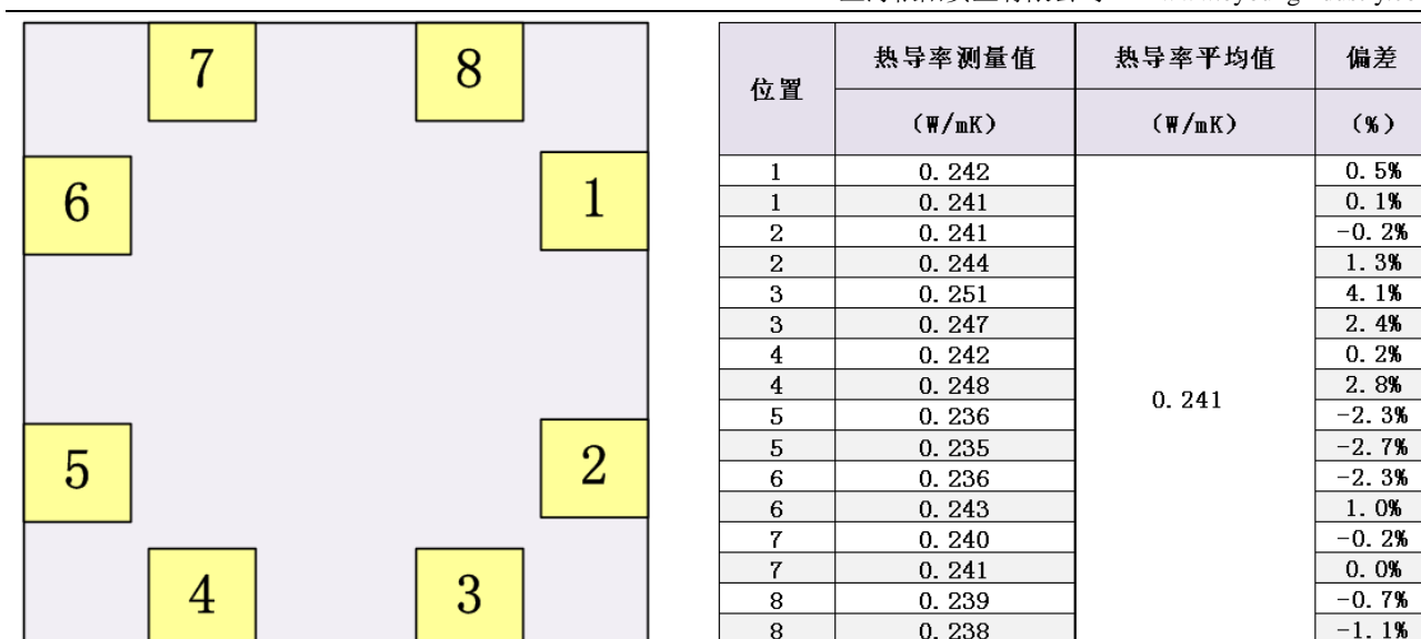
图 3-1 硅酸钙隔热材料试样不同测试位置示意图和热导率测试结果
