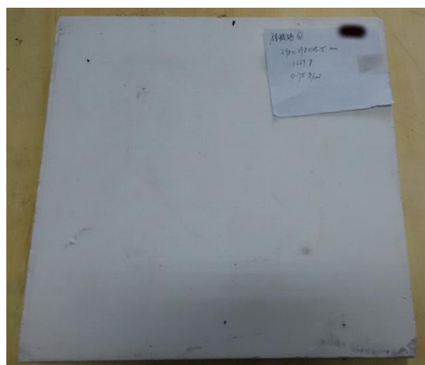
图 2-2 硅酸钙隔热材料 2 号试样
