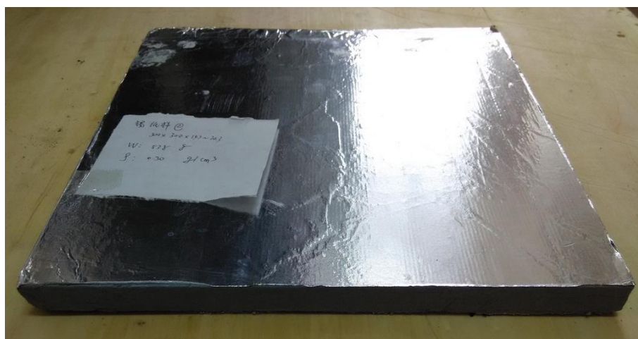
图 2-4 纳米超级隔热材料 2 号试样
