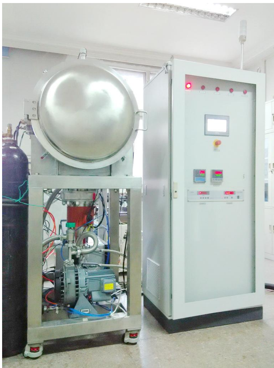
图 2 低温变真空环境材料热物理性能测试系统
