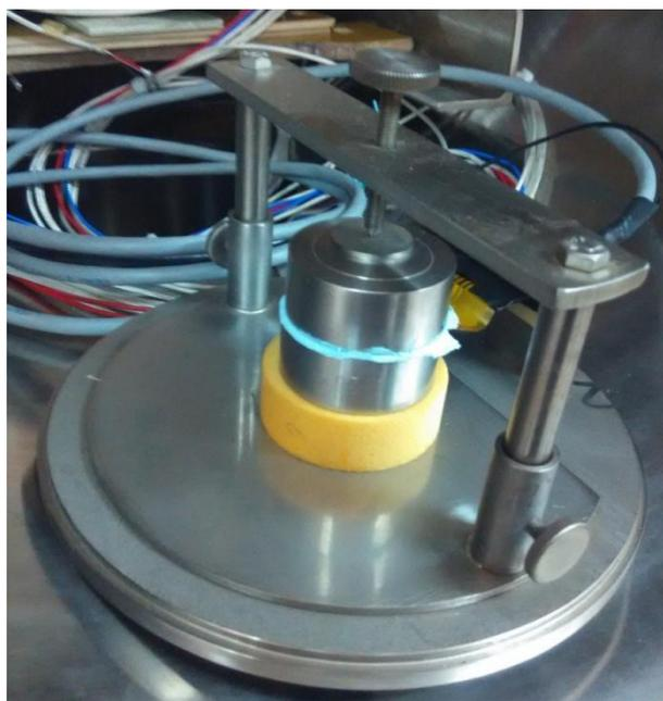
图 10 涂覆导热硅脂后的不锈钢试样测试状态
