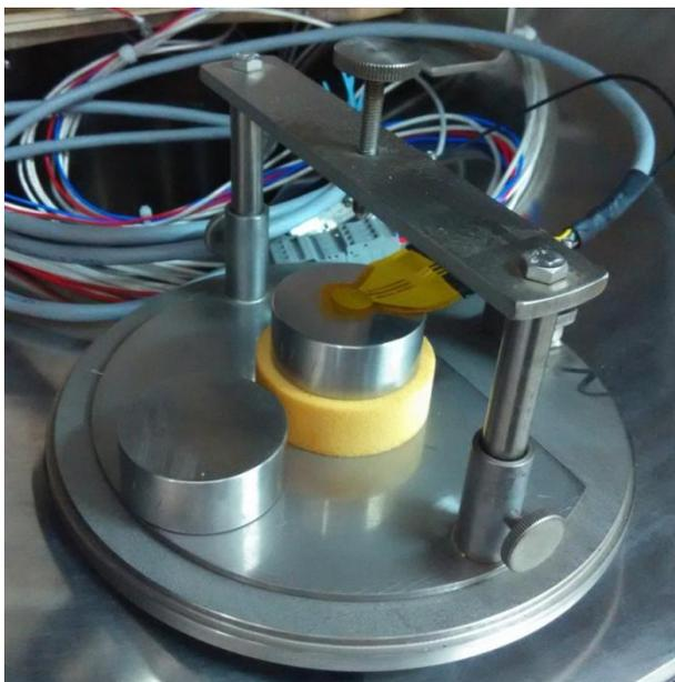
图 3 已知热导率的被测不锈钢试样
