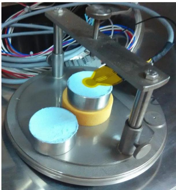
图 9 涂覆导热硅脂的已知热导率被测不锈钢试样
