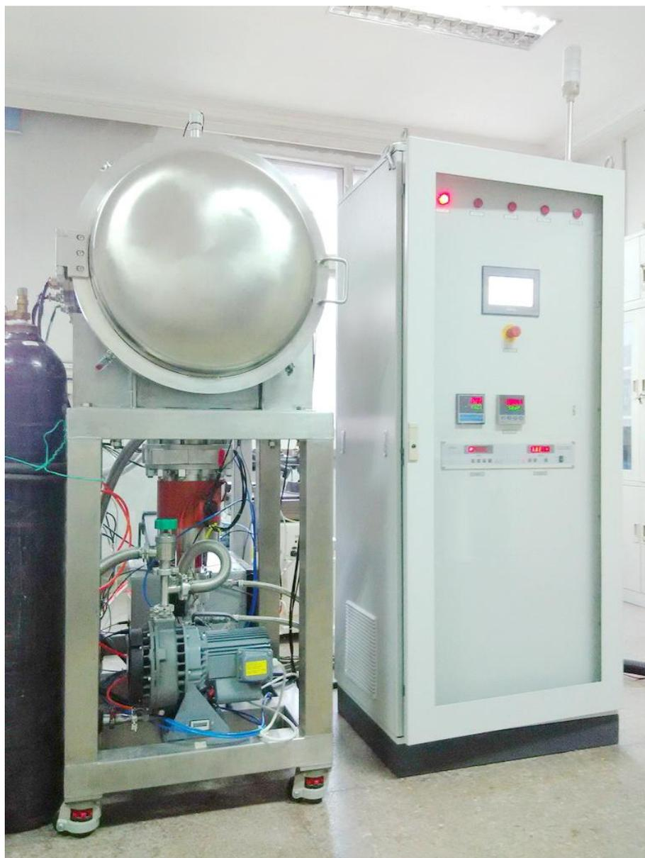
图 1 低温高真空环境材料热物理性能测试系统
