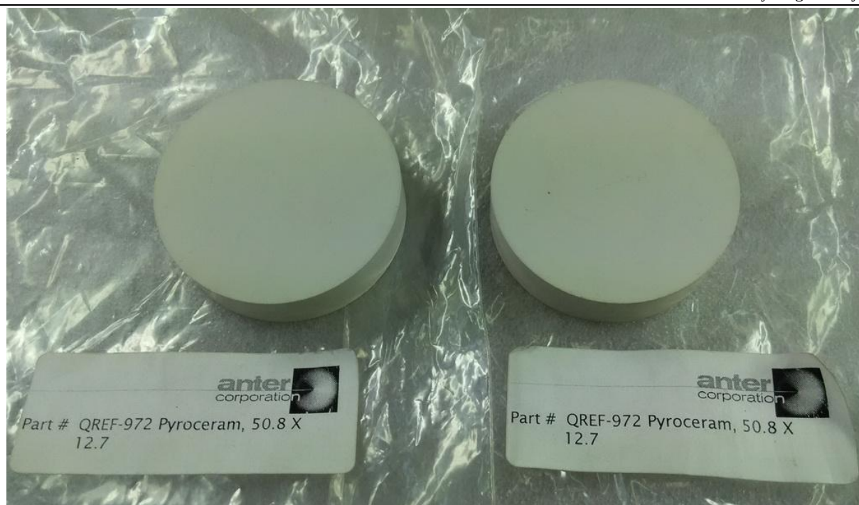
图 3 美国 ANTER 公司参考材料 Pyroceram 9606 (高温陶瓷)
