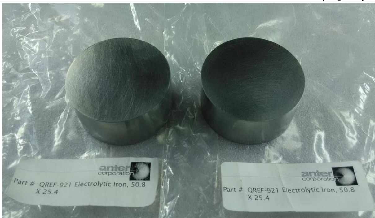
图 7 美国 ANTER 公司参考材料 电解纯铁
