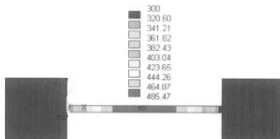
图 4.10 一定施加电压 (4.0V) 时的稳态温度分布即冷却初始温度分布: 空气间隙 3\mu\text{m}
