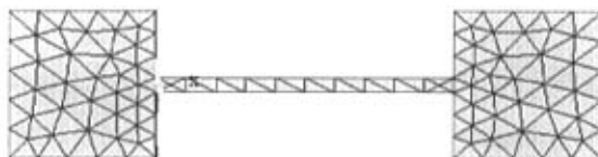
图 4.2 电阻温度系数在线提取双端固支梁结构的热电分析网格划分 (提取结构 1)
