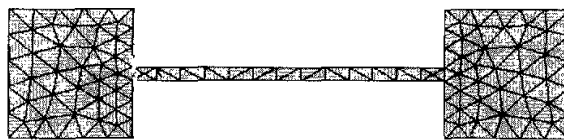
图 4.9 三维热电分析网格划分示意图 (提取结构 2)
