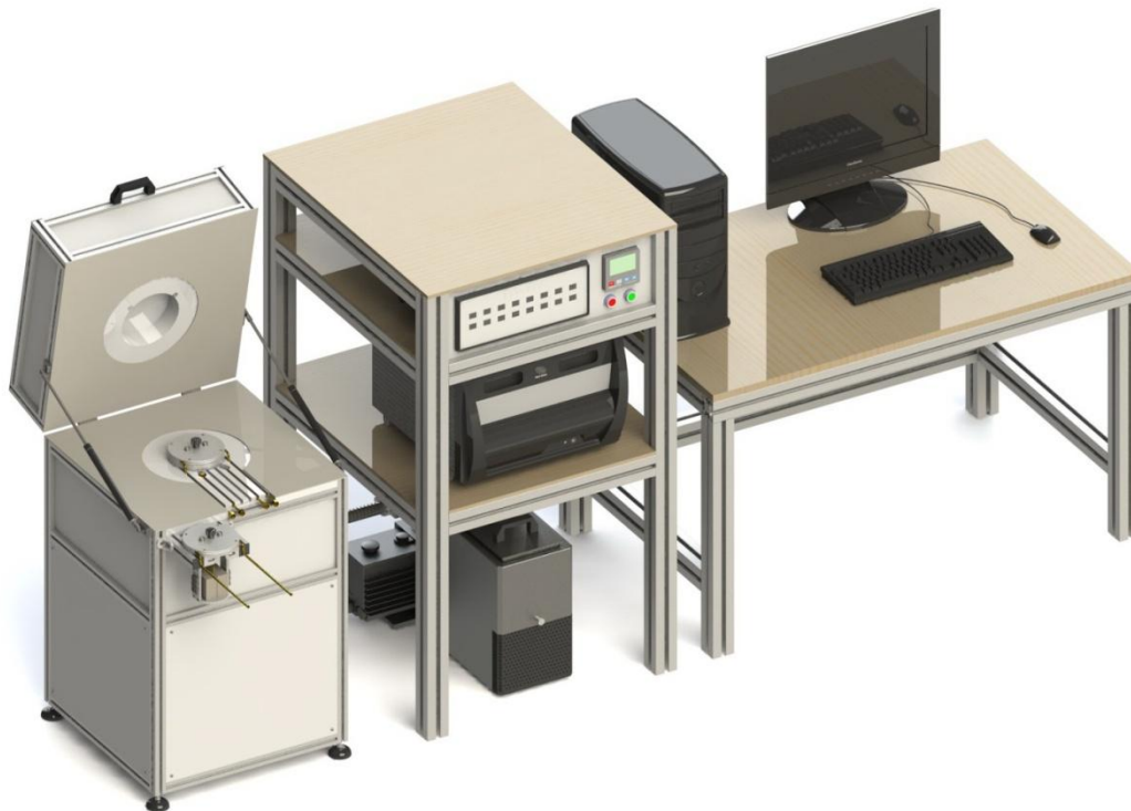
图 2-1 上海依阳公司瞬态平面热源法导热系数测试系统
