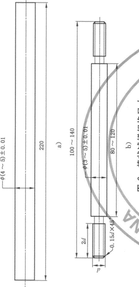
图 2 棒状试样规格尺寸
