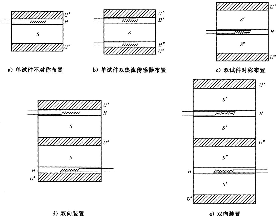
图 1 热流计装置的典型布置图
