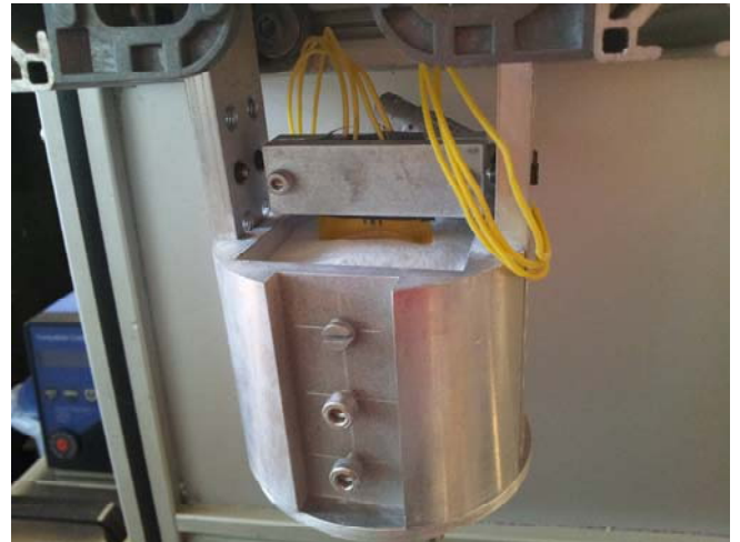
气凝胶粉体热导率测量试样盒
