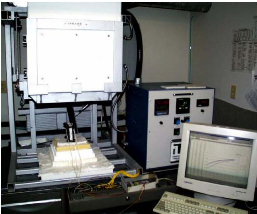
图 3-11 单调加热法高温热扩散率测量装置加热炉升起状态
