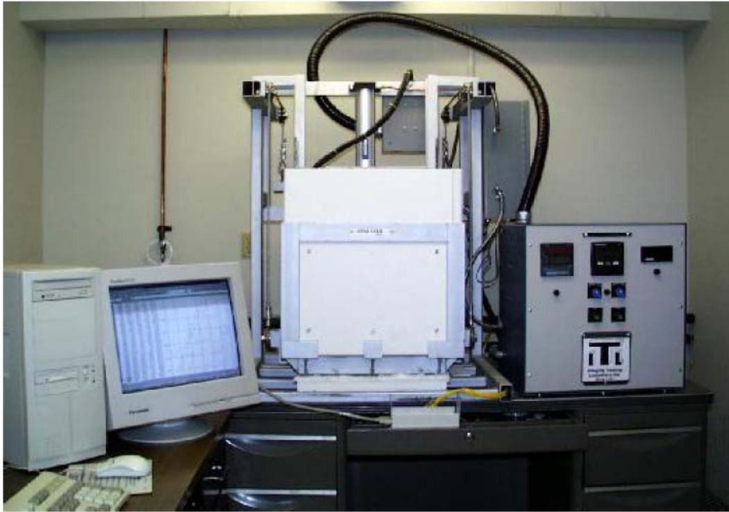
图 3-10 单调加热法高温热扩散率测量装置
