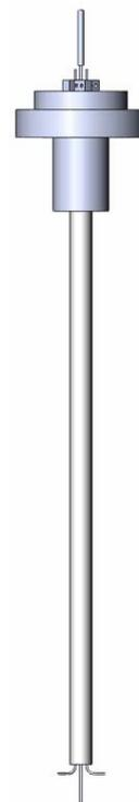
图 3-3 试样支架和熔断装置
