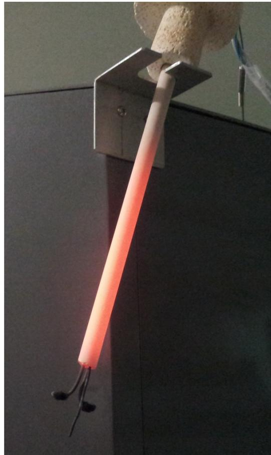
图 5-12 自然冷却中的试样架
