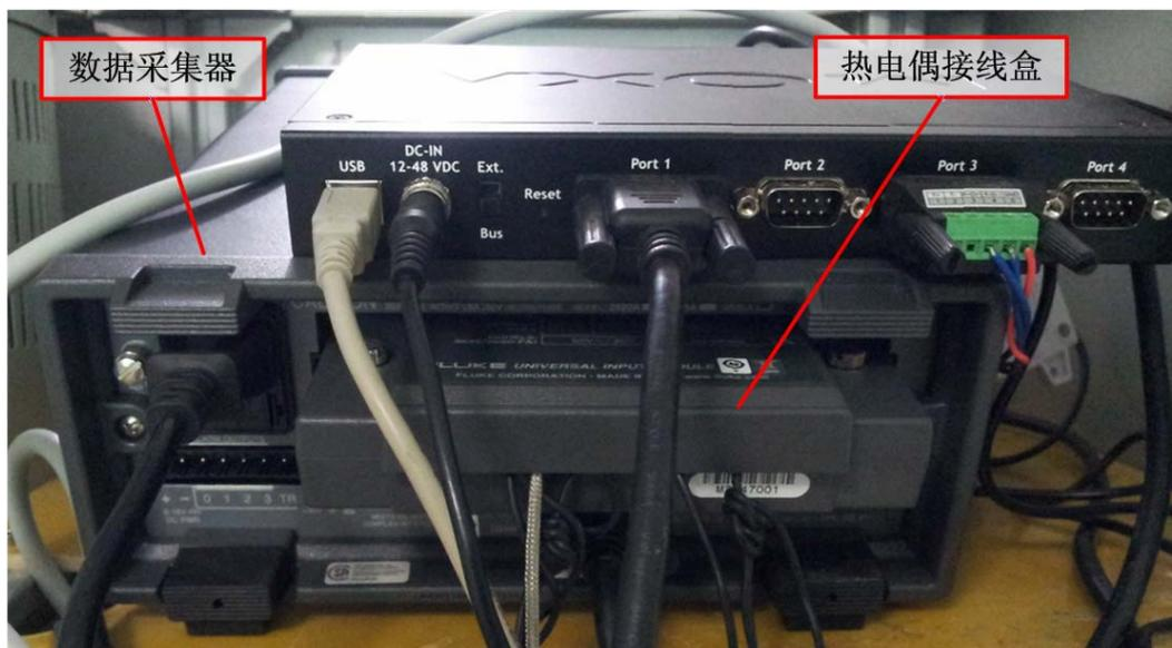
图 7-1 接有引线的数据采集器背面
