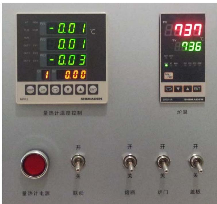
图 5-11 比热容测定仪操作面板
