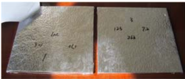
图 3-3 金属薄膜密封的真空绝热板
